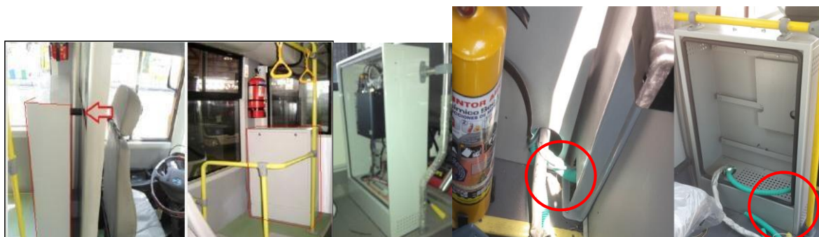
Figura 1. Ubicación gabinete CC. Detrás del panel de la silla de conductor (La figura es sólo ilustrativa)
