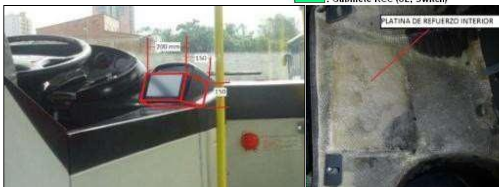
Figura 7. Detalle de dimensiones y ubicación de consola del conductor (La figura es sólo ilustrativa)
