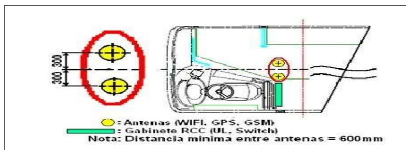
Figura 5. Ubicación de la antena WIFI y de la antena dual de comunicaciones (celular, GPS)
